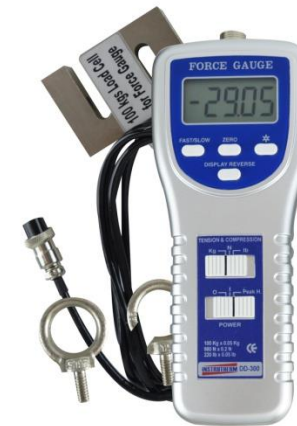
Figura 15 – Dispositivo para ensaio de resistência ao rasgo
